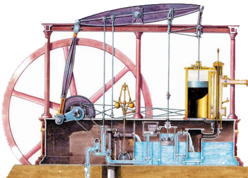
La máquina de vapor de James Watt, patentada en 1769.
