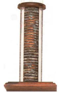
La pila de Volta.
