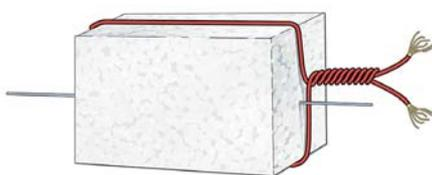
telgopor, de sección rectangular para mayor simplicidad. Deben enrollar el cable como muestra la figura, dejando los extremos libres y pelados, que se llaman **delgas**. En la mayoría de los motores reales, para mejorar su funcionamiento, se colocan varias bobinas. Cada una termina en un par de delgas. A su conjunto se lo llama **colector**.
